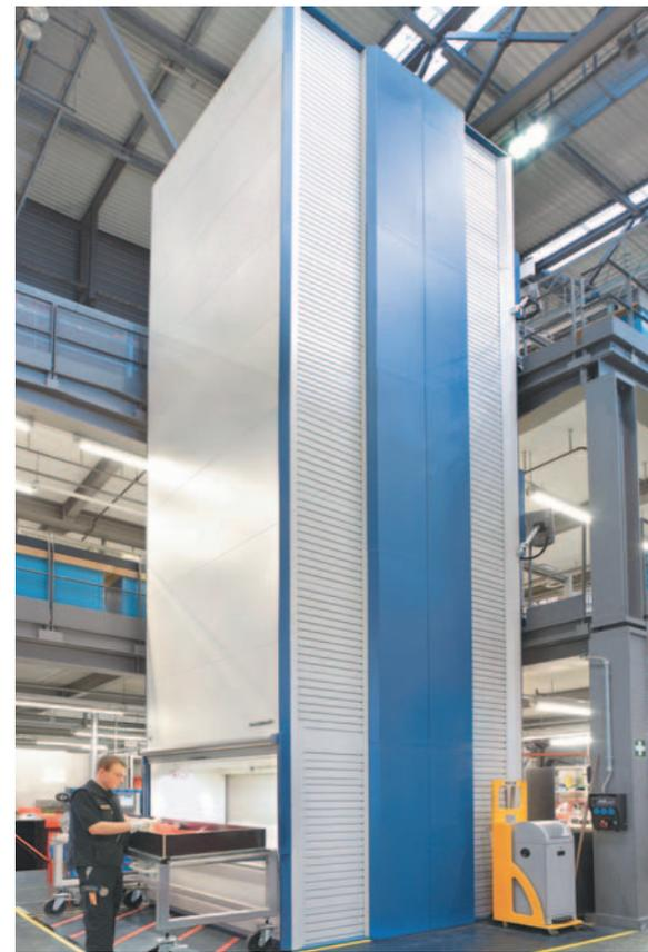
*Die im Rumpfbereich des Jets ausgebauten Kleinteile werden sofort im Lean-Lift eingelagert. Falls eine Reparatur oder Wartung notwendig ist, informiert der Techniker die Mechaniker in den Instandhaltungswerkstätten.*
