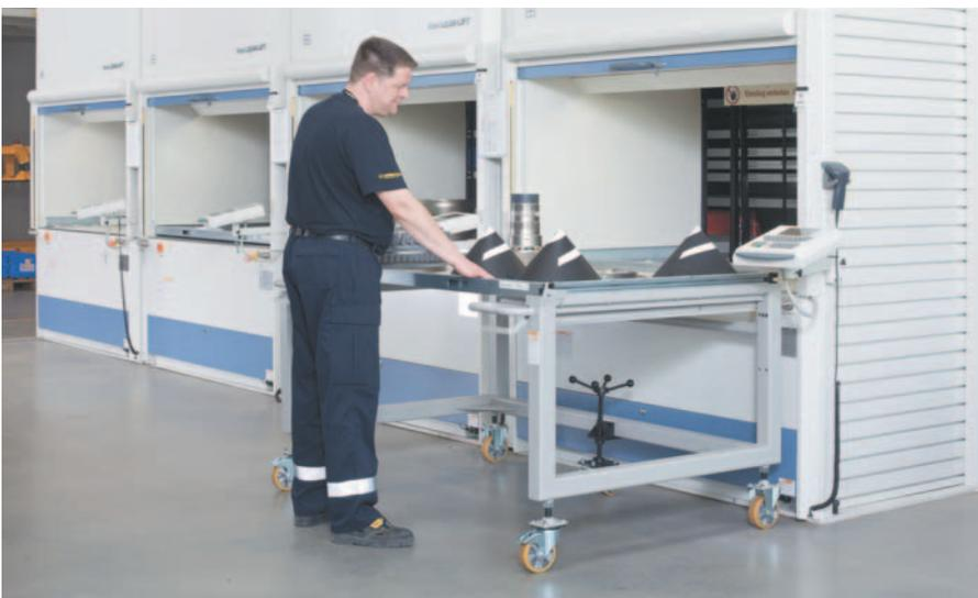
*Mit einer ausgeklügelten Verschiebemechanik können die Tablare mit Triebwerksteilen bequem auf einen Transportwagen abgestellt werden.*
