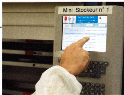
Nouvel écran tactile sur les pupitres de commandes du Lean-Lift.
